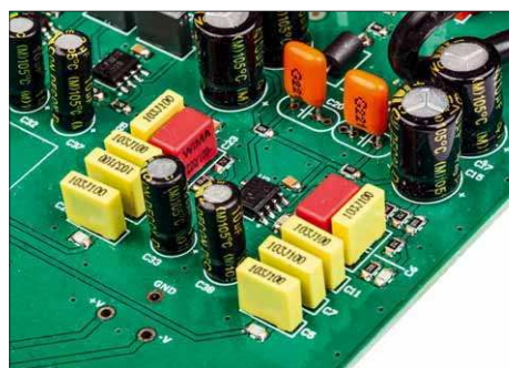
In der Entzerrung kommen bessere und enger tolerierte Bauteile zum Einsatz als beim Vorgänger
