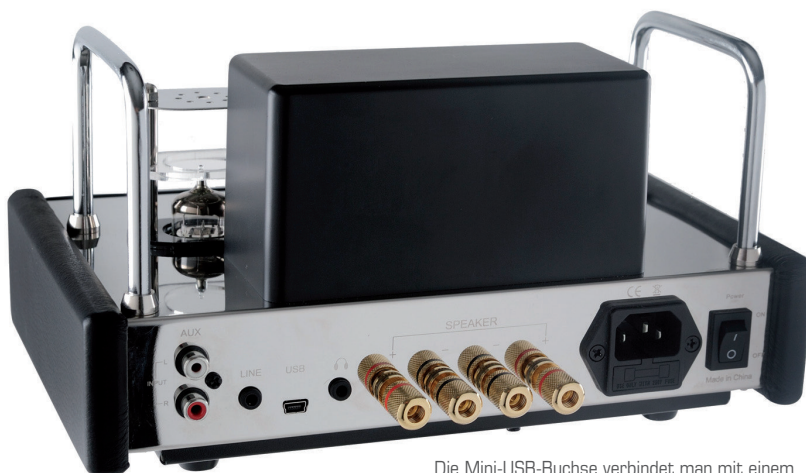
Die Mini-USB-Buchse verbindet man mit einem Computer, in die Klinkebuchse kommt am besten einer der Wireless-Empfänger von Blue Aura
