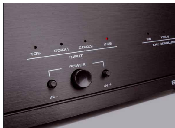
Vier digitale Eingänge hat der DAC, alle sind bis 192 kHz spezifiziert
