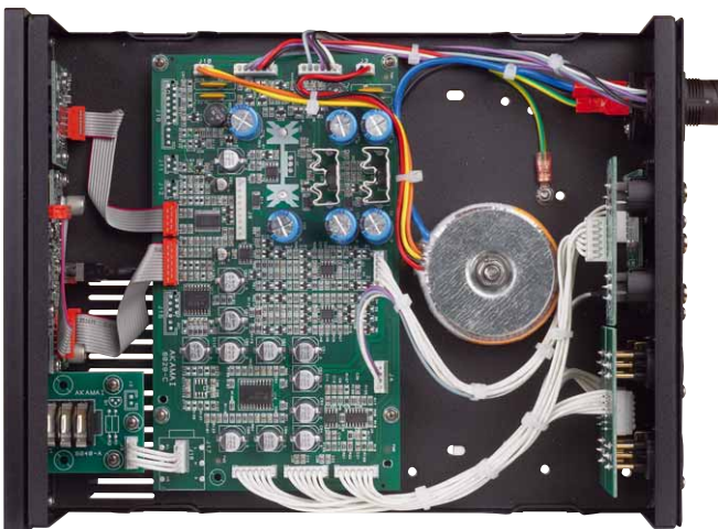
In der Vorstufe ist jede Menge los. Unten in der Mitte sitzt der Kopfhörer-OP, links oberhalb von ihm ist der Pegelsteller verbaut
