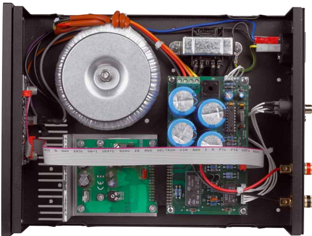
Die M-7 ist ein toll aufgebauter Schaltverstärker mit großem Trafo
