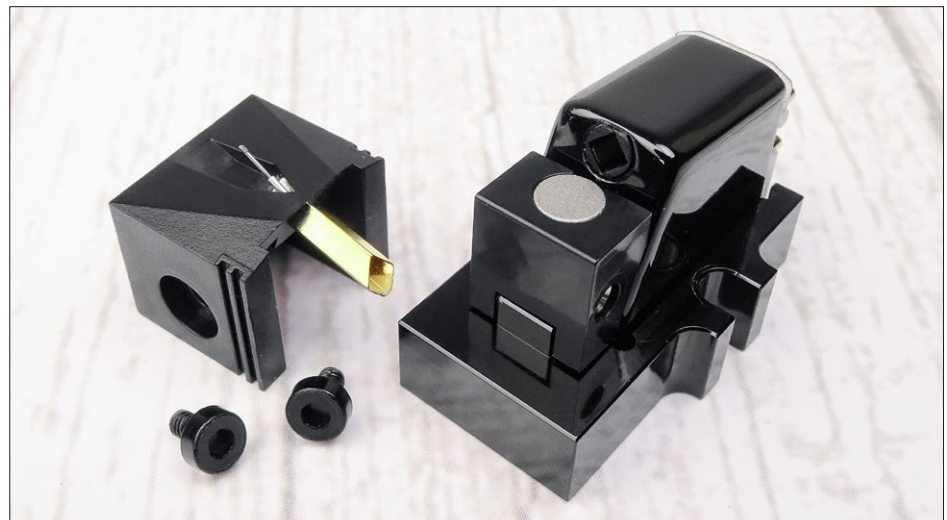
Im Falle von Beschädigung oder Abnutzung lässt sich nach dem Lösen zweier Schraubchen der Nadeleinschub für einen Tausch ganz einfach aus dem Tonabnehmergehäuse ziehen.
