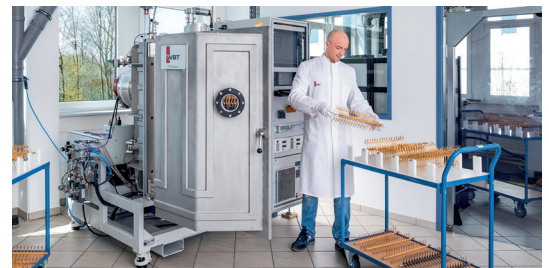
PVD-Plasma Reaktor für nano-strukturierte Oberflächenmodifikationen mit Au, Pd, Pt, Ag, Cu, etc.
